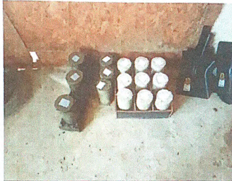
CORPO DE PROVA PARA ROMPIMENTO
