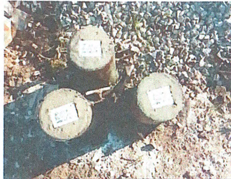
CORPO DE PROVA PARA ROMPIMENTO
