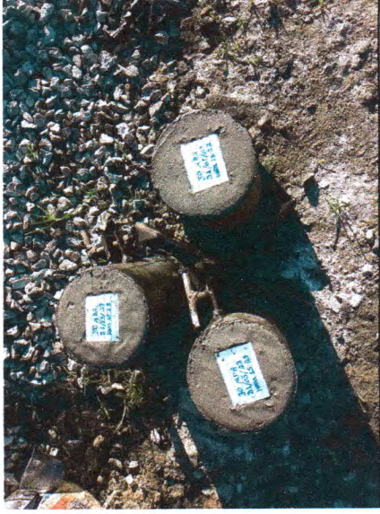
CONTROLE TECNOLÓGICO DO CONCRETO; MOLDAGEM DE CORPO DE PROVA
