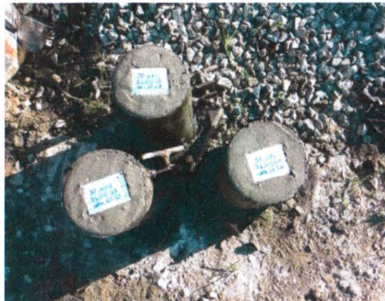
CORPO DE PROVA PARA ROMPIMENTO;
