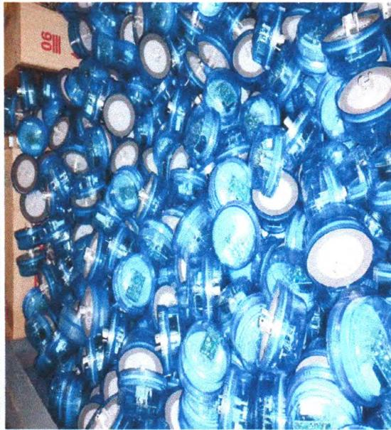
Foto 14 – Relés Fotoelétricos – Equipamento utilizado para o acionamento da Luminária ao anoitecer
