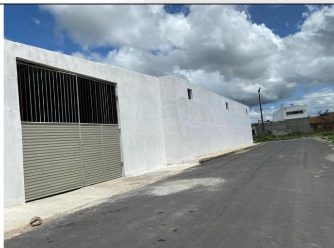
*Foto 07: Calçadas com desníveis e sem largura mínima adotada por norma (sem acessibilidade)*
