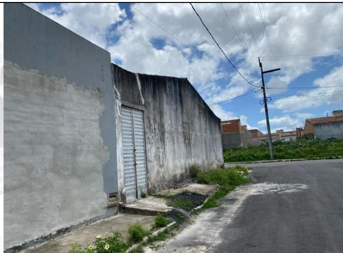
*Foto 06: Calçadas com desníveis e sem largura mínima adotada por norma (sem acessibilidade)*
